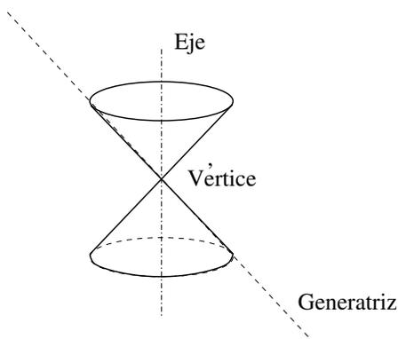
La recta  $h$  se denomina **eje del cono** y las distintas posiciones de  $g$ , **generatrices del cono**; el punto de intersección del eje con una generatriz cualquiera del cono se denomina **vértice**.
